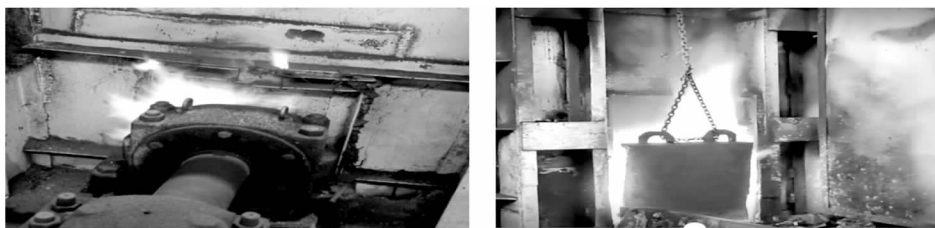
图2 炉膛压力过大
