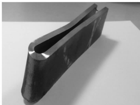
图 1 12 mm 厚试验钢的冷弯照片
