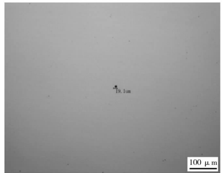
图 4 12 mm 厚试验钢夹杂物照片
