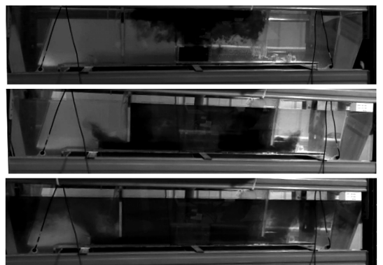
图 2 方案二中间包内钢液的流动状态
