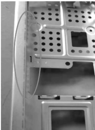
图 1 包钢冲压电脑机箱发黑试样
