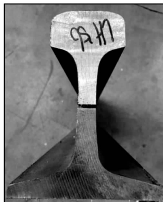
图6 美标轨腰切口法检测轨腰残余应力
