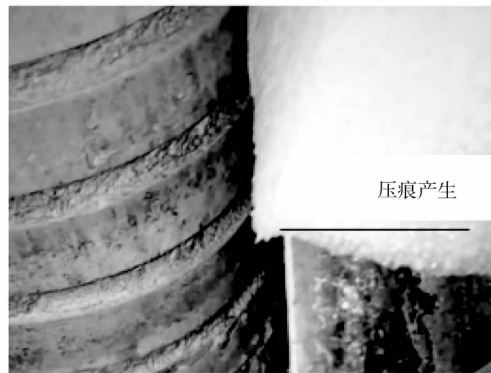
图7 压痕形成过程模拟
