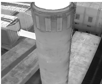
图1 烟囱红外热成像图
