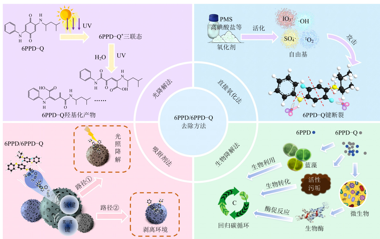
图3 6PPD/6PPD-Q去除策略及机理示意图
