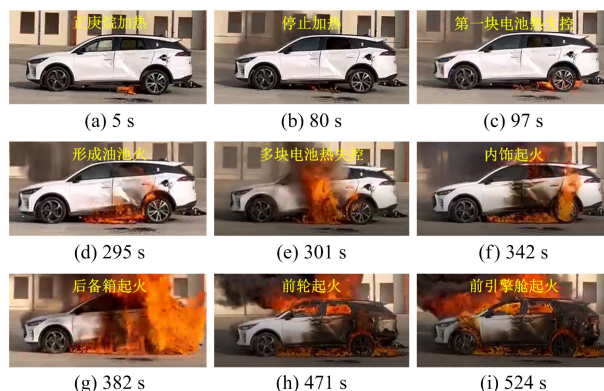
图5 电动汽车火灾发展过程
