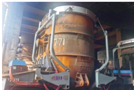
图 6 铁水罐实施加盖保温现场照片
