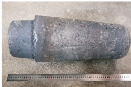
图1 实验熔炼的50 kg中锰钢铸锭
